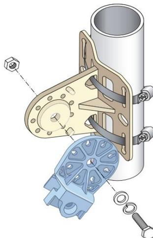
3. 将 AP 的支架滑入安装支架的开口,使用包装中的两颗 M6x20 螺钉将 AP 固定到安装支架上,如图 17 所示。
