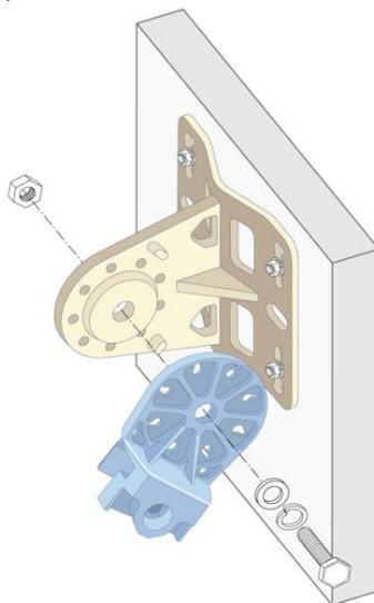
7. 将 AP 的支架滑入安装支架的开口,然后使用包装中的两颗 M6x20 螺钉将 AP 固定到安装支架上,如图 13 所示。
