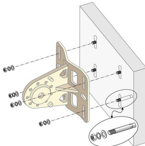
6. 使用包装内的 M10x30 螺丝（带垫圈）和 M10 螺母固定安装件固定器到安装支架,如图12所示。
