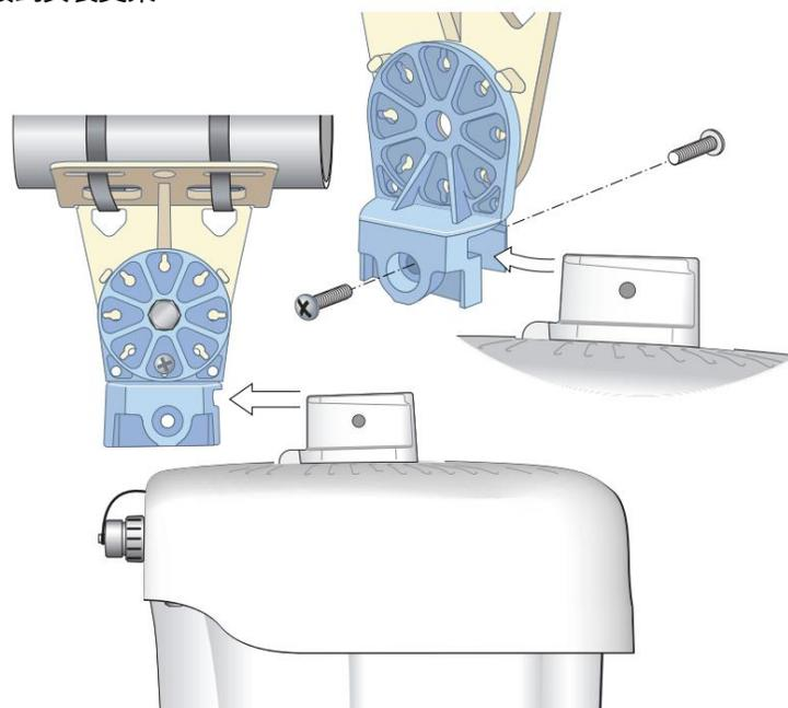
图 10将 AP 连接到安装支架（已完成）
