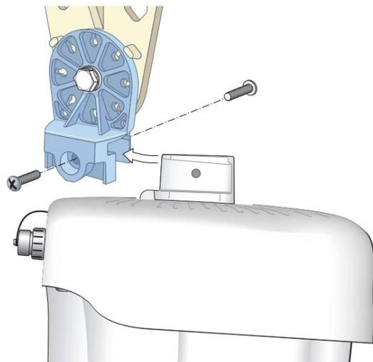
图 5将 AP 连接到安装支架（已完成）
