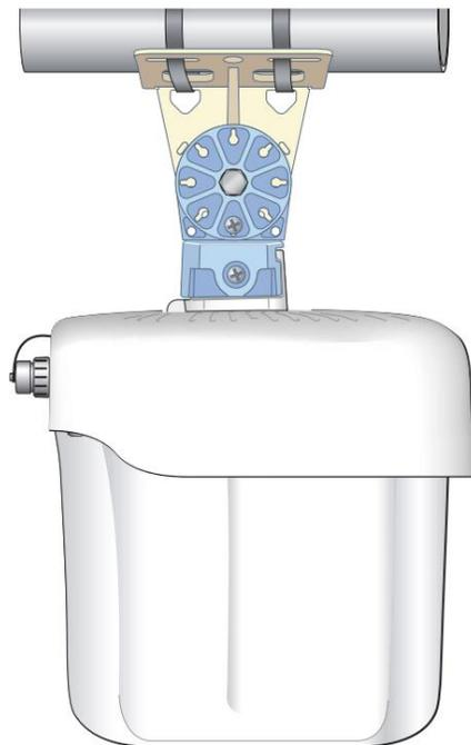
通过将 M6x20 螺钉（包含在包装中）插入安装支架上的不同孔中,AP（安装到安装支架）的倾斜度可以调整到 +/-45 度,如图 6所示。
