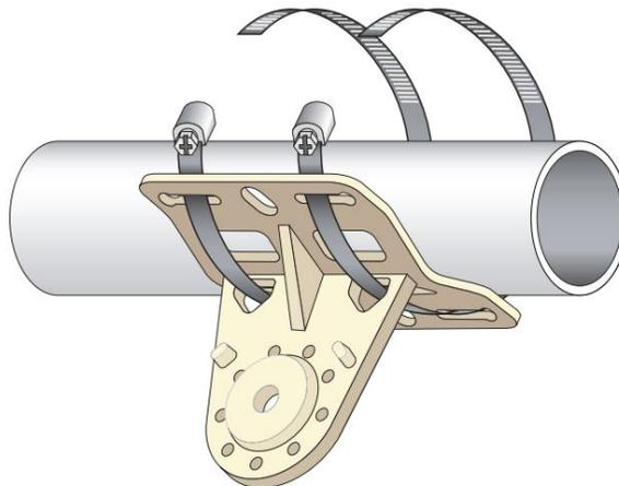
2. 使用包装内的 M10x30 螺丝 (带垫圈)和 M10 螺母固定安装件固定器到安装支架,如图8所示。
