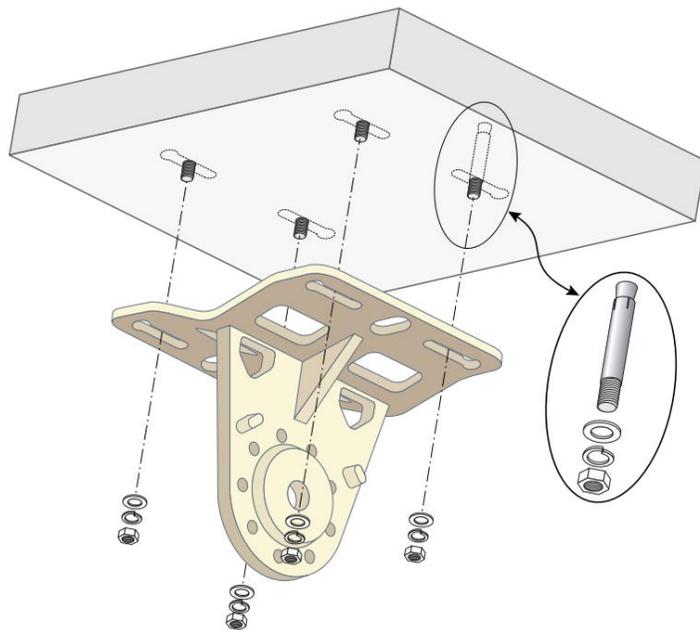
6. 使用包装内的 M10x30 螺丝 (带垫圈)和 M10 螺母固定安装件固定器到安装支架,如图3所示。
