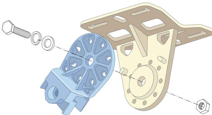
7. 将 AP 的支架滑入安装支架的开口,使用包装中的两颗 M6x20 螺钉将 AP 固定到安装支架上,如图 4所示。
