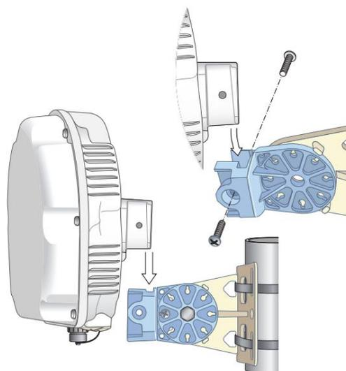
图 18将 AP 连接到安装支架（已完成）
