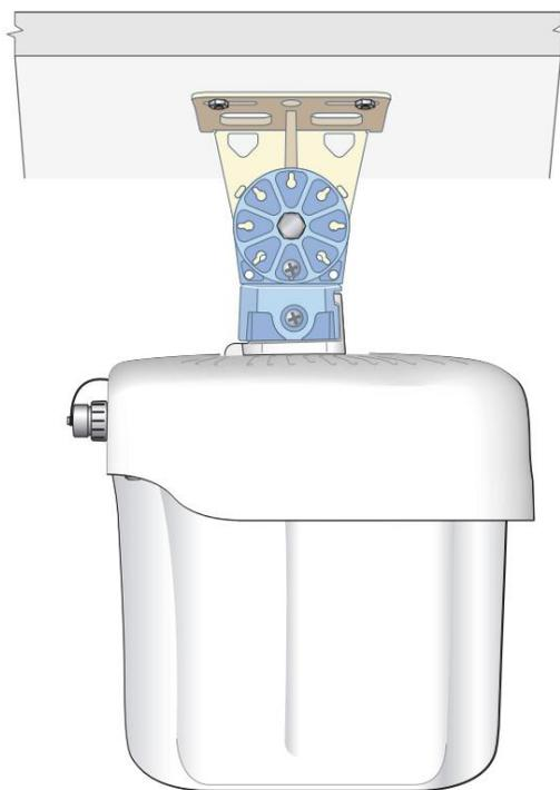
通过将 M6x20 螺钉（包含在包装中）插入安装支架上的不同孔中,AP（安装到安装支架）的倾斜度可以调整到 +/-45 度,如图 6所示。
