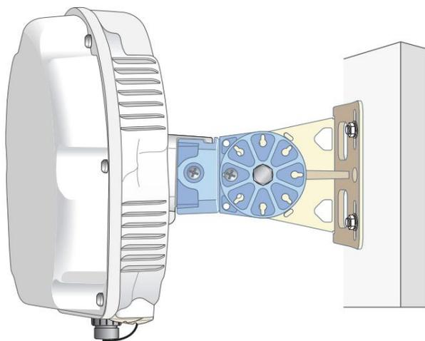
通过将 M6x20 螺钉（包含在包装中）插入安装支架上的不同孔中,AP（安装到安装支架）的倾斜度可以调整到 +/-45 度。
