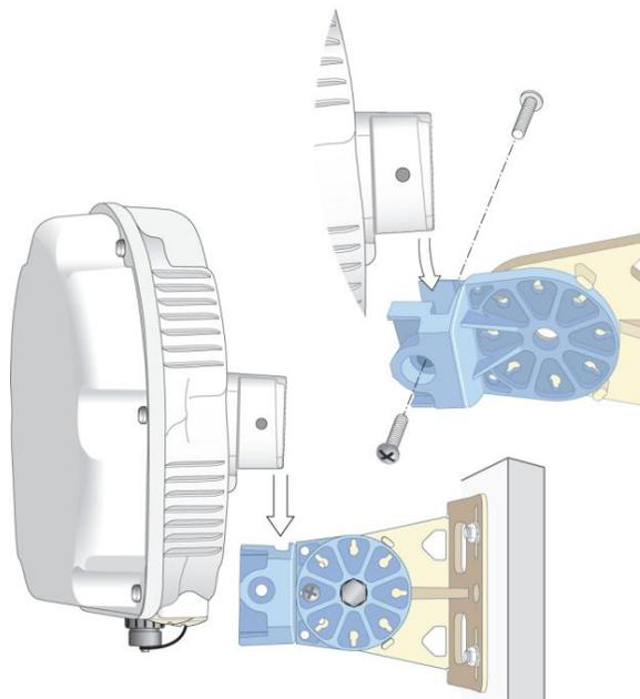
图 14将 AP 连接到安装支架（已完成）
