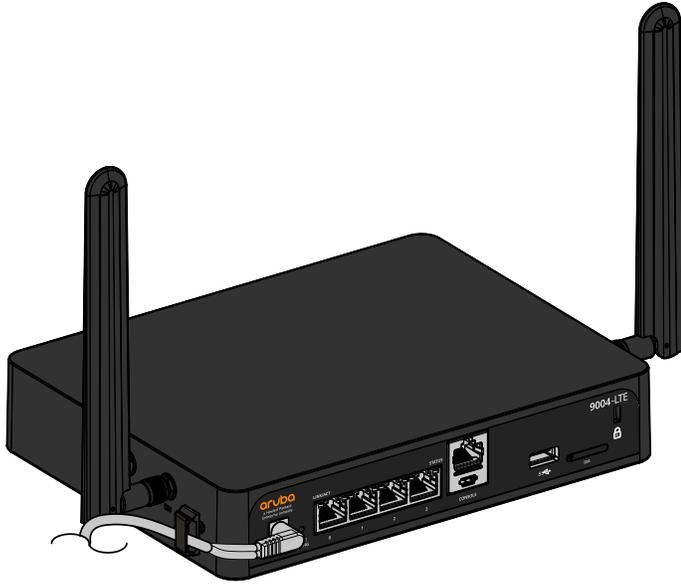
电缆鞍的安装现已完成。
