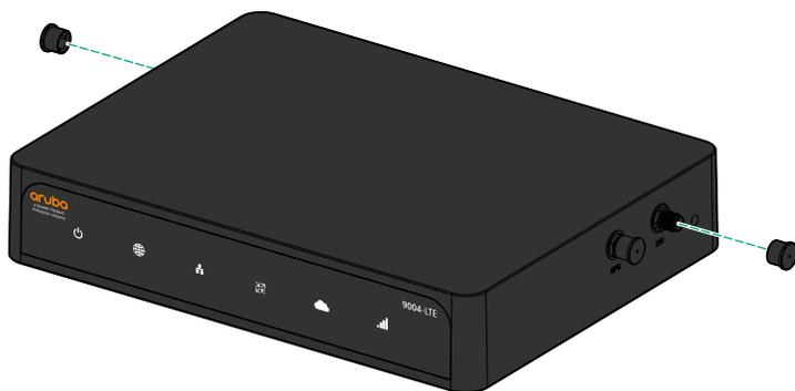
2. 使用适当的扩展电缆（Aruba 90xx-LTE 天线扩展套件 20 英尺或 Aruba 90xx-LTE 天线扩展套件 40 英尺天线套件）将 LTE 天线与设备连接。请参阅图 30。
