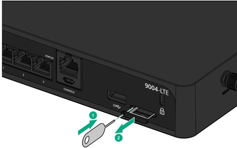
2. 拉出 SIM 卡槽，然后将 SIM 卡（金触点朝下）插入 SIM 卡槽。
