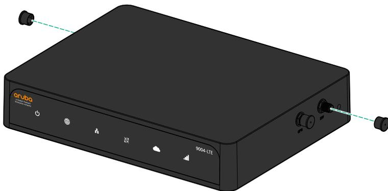
2. 将 LTE 天线连接器与设备上提供的连接器对齐。
