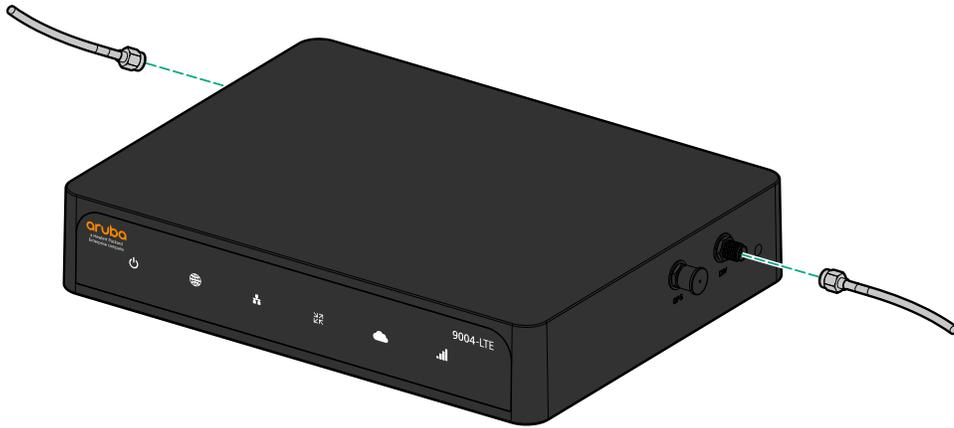
3. 将延长电缆的一端与设备上的 LTE 连接器对齐，然后将电缆与连接器固定在一起。
